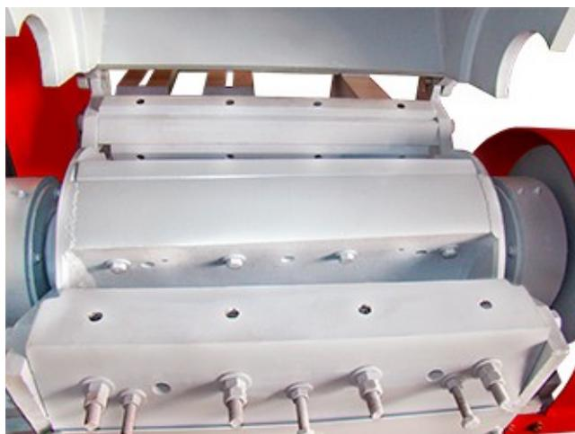
Moinho granulador para moagem de borras plásticas, cobre, borrachas e outros produtos. As facas e contra-facas são fabricadas em aço indeformável, temperadas e retificadas, sendo reguladas micrometricamente.
